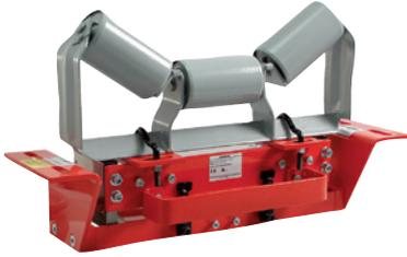
Конвейерные весы MSI (Milltronics Single Idler) и MCS (Milltronics Crusher Scales) предназначены для установки в ленточный конвейер и служат для непрерывного взвешивания сыпучих веществ. Весоизмерительная система дополняется предоставляемой и монтируемой клиентом на весоизмерительный мост роликковой опорой. Весоизмерительные ячейки конвейерных весов MSI и MCS подают пропорциональный нагрузке электрический сигнал на весоизмерительный модуль.
